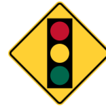
Signal avancé de feu de circulation Ralentir
